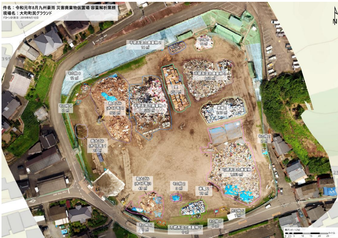
図 4-2 ドローンによる体積計測事例 (佐賀県大町町仮置場)
